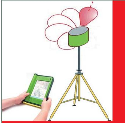
Рис. 8. Радар обзора территории, установленный на треноге
