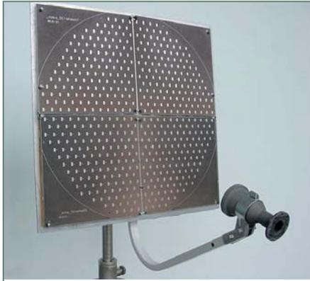
Рис. 7. Опытные образцы ФАР на частоту 12 ГГц, 532 излучателя с варакторами МА46Н120
